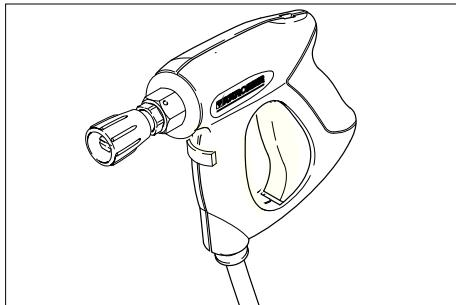
→ Ventil za doziranje deterdženta namestite na željeni deterdžent i željenu koncentraciju.
