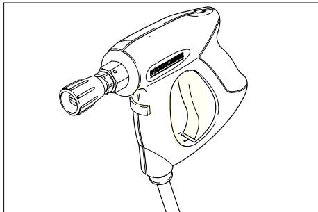
→ Dávkovací ventil čisticího prostředku nastavte na požadovaný čisticí prostředek a požadovanou koncentraci.
