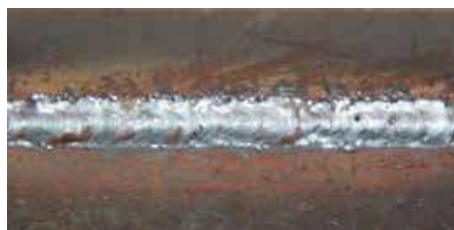
Рис 9.1. Сварной шов при минимальном значении индуктивности.
