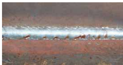
Рис 9.2. Сварной шов при максимальном значении индуктивности.
