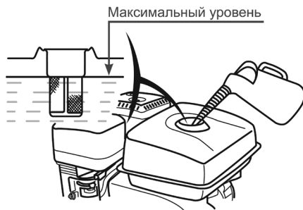
Рис. 5 Максимальный уровень топлива в топливном баке
